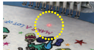
Laser Pointer 激光落针点
