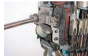
Automatic Presser Foot Height Adjustment 自动压脚装置
