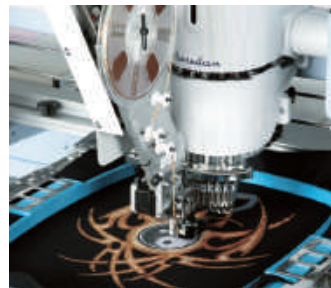
■ YN Sequin Device ● 圆头珠片装置
